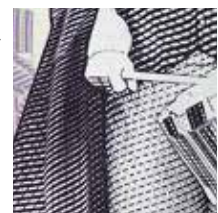
Trama de seguridad en impresión calcográfica: tactilidad perceptible
