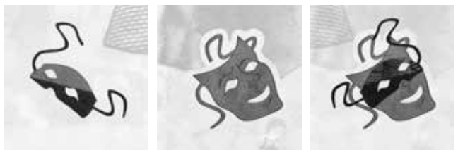
Registro de transparencia infrarroja: para la mayor precisión de impresión calcográfica
