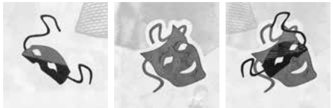
Points de repère IR en transparence: pour une taille-douce de haute précision
