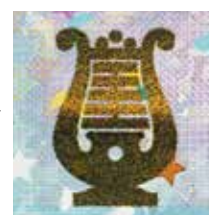
SPARK®: couleur variable en fonction de la lumière incidente
